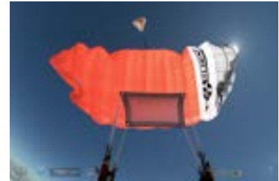
Geschlossene Außenzellen und Slider hängt fest
