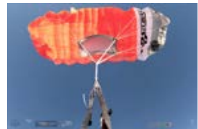
Leichte Fangleinenverdrehung, außerdem geschlossene Endzellen und festhängender Slider
