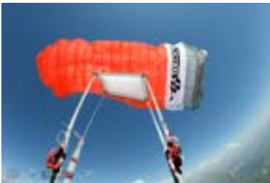
Fangleinenriss vorne links, der Fallschirm dreht sich
