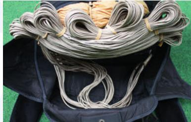
Die Überlänger in die unteren Ecken des Containers legen. Die restliche Überlänge in der Mitte ordentlich verlegen. **Der zweite Check steht an!**
