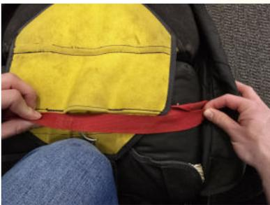
Mit dem Knie fixieren und die Bridle auf der oberen Klappe ablegen. Der Pin sollte jetzt auf Höhe der Öse sein und die Überlänge auf dem Pod liegen. Der Hilfsschirm ist links neben dem Gurtzeug
