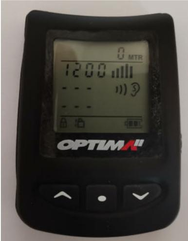
Der **akustische Höhenwarner**, auch „Dytter“, ist ein kleines Gerät, welches im Helm (am Ohr) platziert wird und dir ein akustisches Signal (Piepen) gibt, wenn du auf bestimmten Höhen bist. Du kannst mehrere Höhen eingeben, so dass es beispielsweise bei der Höhe piepst, bei der du deinen Schirm öffnest und bei der Höhe, in der du deine Landeinteilung beginnst.
