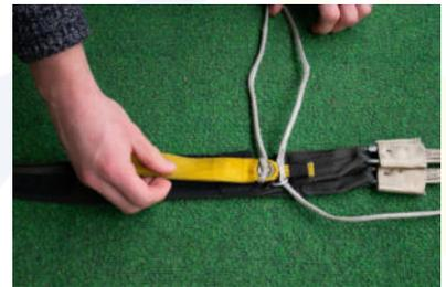
Die Schlaufe durch das Auge stecken, stramm am Ring fixieren, darüber in die Lasche stecken und festkletten
