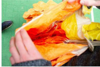
Die zweite Kammer ist zwischen den beiden Sliderösen. In der zweiten Kammer den Stoff zwischen den B- und C-Leinen nach außen legen
