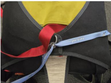
Den Pin von unten nach oben durch den Loop stecken
