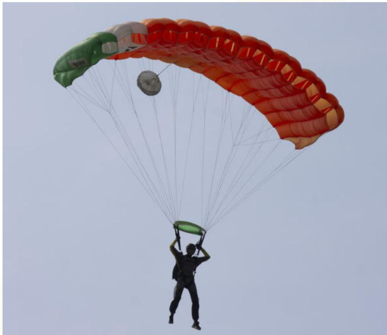
Dein **Hauptschirm** (auch **Hauptfallschirm** oder **Hauptkappe**) trägt dich sicher zum Erdboden. Er ist wie eine Tragfläche geformt und fliegt selbständig vorwärts durch die Luft. Die dabei erzeugte Luftströmung über die Tragfläche bewirkt an der Oberseite des Fallschirms einen Unterdruck und an der Unterseite einen Überdruck. Die Kombination aus den beiden Kräften bewirkt einen Auftrieb, der uns in der Luft hält.
