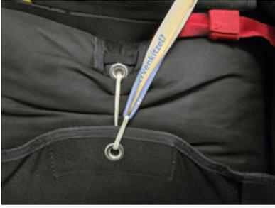
Das Packband durch die Öse der unteren Klappe führen und ziehen, bis der Loop weit durch die Öse ist
