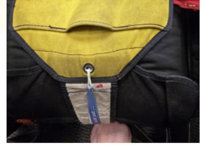
Das Packband durch die Öse der oberen Klappe führen und ziehen, bis der Loop durch die Öse ist
