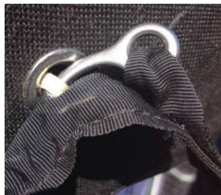
Abbildung 8: Hilfsschirmverbindungsleine von Pin durchbohrt
