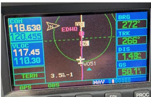
Das GPS der Porter im Anflug: 1,43 Meilen („DIS“) vor dem Absetzpunkt. Die Airspeed beträgt 60 kts (nicht im Bild), durch den Gegenwind von 10 kts fliegt die Porter nun mit einer Groundspeed („GS“) von 50,1kts.
